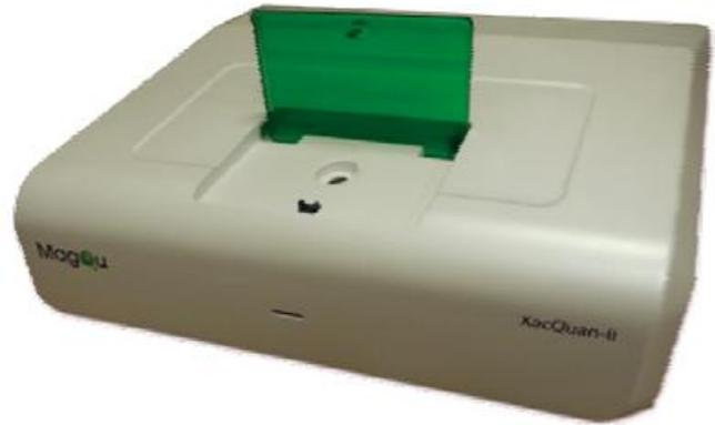
MagQu社の提供する『交流磁化率測定装置 XacQuan』は、リン酸化リチウム(LiFePO4)中に含まれている鉄分量の測定が可能です。通常、リチウム電池では、良品の鉄分は比較的low、微量の磁気信号しか測定されません。しかし、不良品は過量の鉄分が含まれており、強い磁気信号が計測されます。『XacQuan』の測定時間はわずか10分以内です。簡単・高速品質検査で大幅な生産効率向上可能です。
